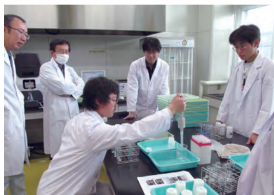
抽出液を試験管に入れて、置換性塩基類を測定します
