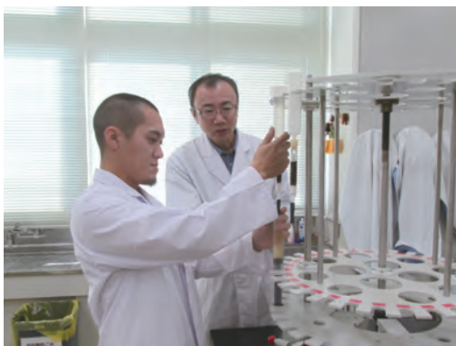
土壌を抽出機にセットして、CEC（陽イオン交換容量）を測定します
