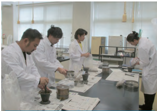
乾燥させておいた圃場の土をすり鉢で砕いた後、ふるいにかけてます。
